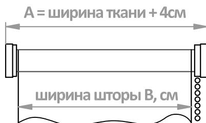
Возможна установка штор на стену, на потолок, в проем.
